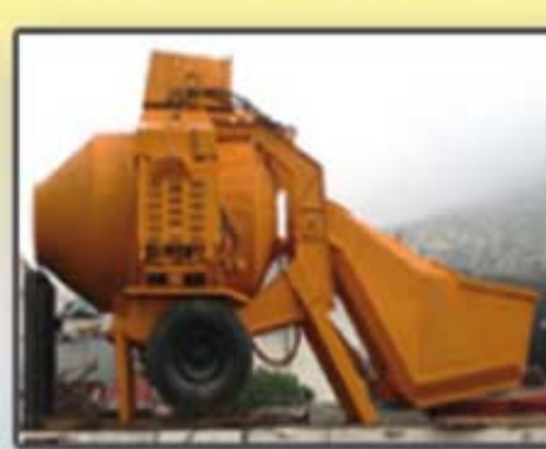
Bétonnière de chantier
